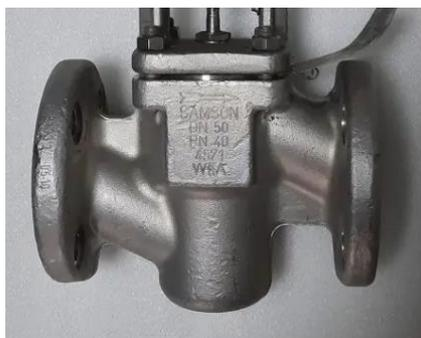
Рисунок 2.3 – Регулирующий клапан SAMSON Type 3241
