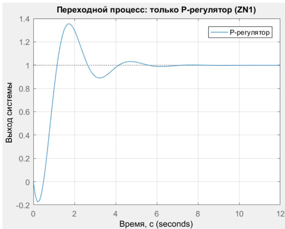
Рисунок 3.6 – переходной процесс P – регулятора ZN1
